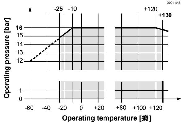
在运行温度-25~+125度，工作压力按照 ISO7268 和 EN1333 分类，符合 DIN4748 和 DIN3158
